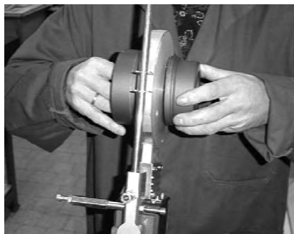
Рис. 2 Муфту и дорн установить на нагревательном элементе.
