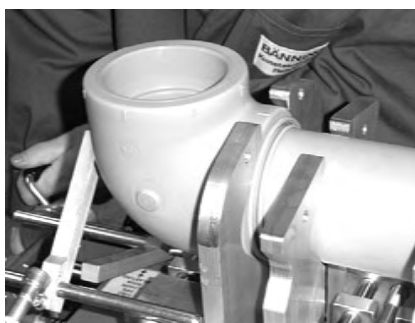
Рис. 11 Сдвинуть каретку до упора
