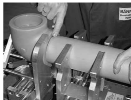
Рис. 8 Трубу вставить в зажим соосно фитингу и установить так, чтобы её торец прилегал к фитингу
