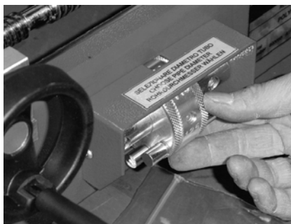
Рис. 4 Выбор диаметра трубы / фитинга
