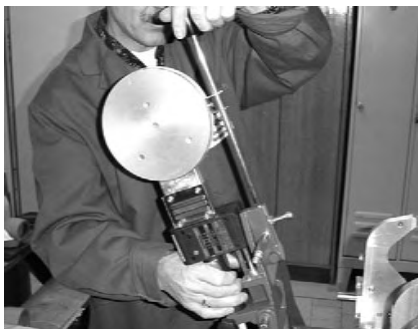
Рис. 1 Нагревательный элемент вставить в крепление.
