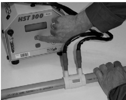
7. Штекеры кабеля вставить в контактные гнёзда. Установить на сварочном аппарате напряжение (V) и время сварки. Все параметры сварки указаны на штриховом коде на наклейке муфты. Начать сварочный процесс, нажав на включатель.
