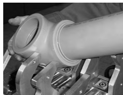
Рис. 12 Сваренные детали извлечь из зажимов по истечении времени охлаждения
