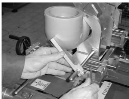
Рис. 7 Закрепить стопор для фиксации фитинга
